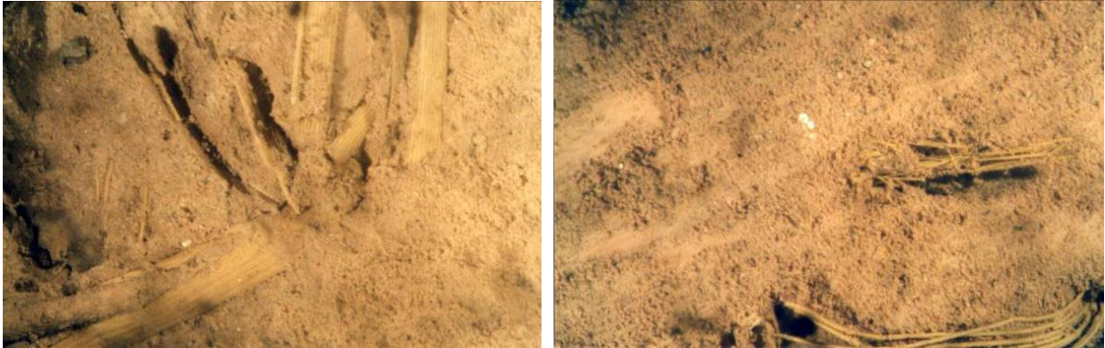
Figura 7.45. Microfotografía por episcopia (6,3X) de la estructura de un ladrillo de adobe de Las Taperas, realizadas por el Instituto de Suelos del INTA. Izquierda, detalle de restos vegetales; Derecha, detalle de restos vegetales y granos minerales
