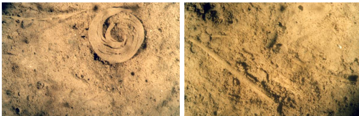
Figura 8.60. Microfotografía por episcopía de la estructura de un bloque de adobe de Las Bateas 4. Realizadas por el Instituto de Suelos del INTA.. A la Detalle de restos vegetales (fotos a 6,3X).
