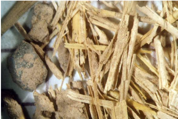
Figura 7.45. Microfotografía por episcopia (6,3X) de la estructura de un ladrillo de adobe de Las Taperas, realizadas por el Instituto de Suelos del INTA. Izquierda, detalle de restos vegetales; Derecha, detalle de restos vegetales y granos minerales
