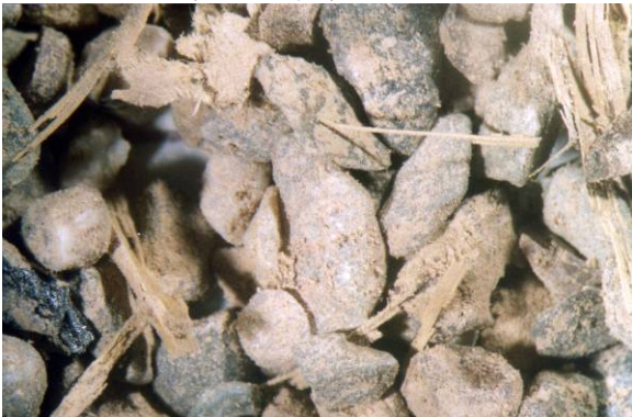
Figura 7.43. Microfotografía por episcopía de la estructura de un ladrillo de adobe de las Tamberías de Guandacol, realizadas por el Instituto de Suelos del INTA. Izquierda, detalle de restos vegetales (foto a 6,3X); Derecha, detalle de restos de carbón (foto a 12,5X).
