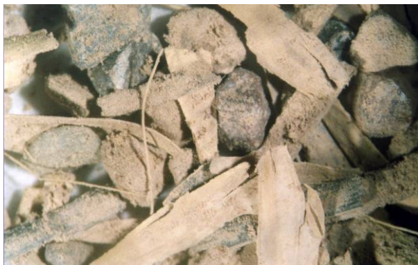
Figura 8.59. Microfotografía por episcopía (6,3X) de residuo tamizado de ladrillo de adobe de Guandacol. Realizada por el Instituto de Suelos del INTA. Detalle de proporciones de gravilla y paja.
