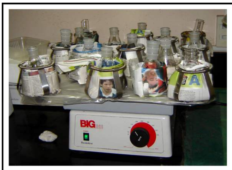
Foto: 6.3: Agitador utilizado para la extracción de fósforo con el Método 3.
