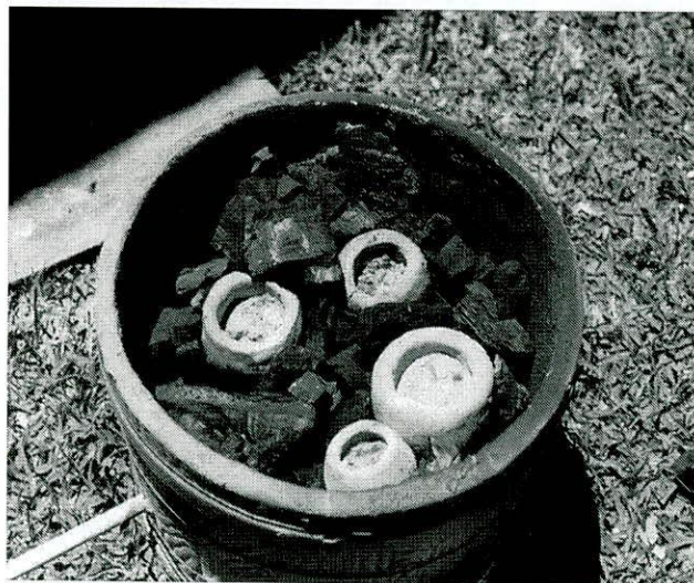
Figura 5.37 Crisoles en el hornillo previo a la experimentación
