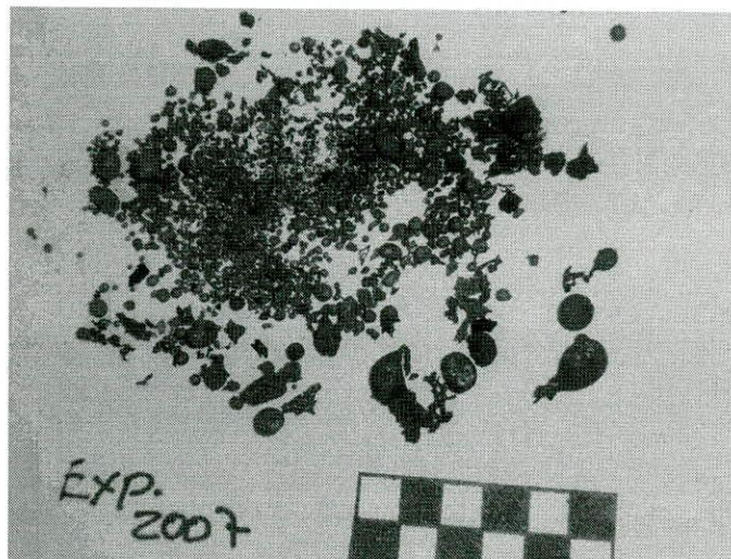
Figura 5.40 Productos de la fundición contenidos en los crisoles experimentales
