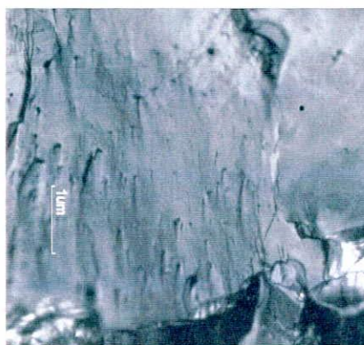
Figura 2.7. Estigmas en forma de cometa. Superficie de fractura en pieza experimental de ortocuarcita GSB. Microscopio metalográfico. 200X.
