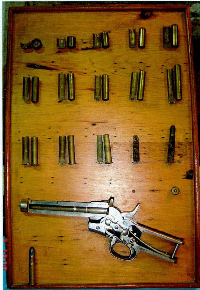
Figura 6.17 Proceso de fabricación de cartuchos Remington
